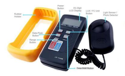
Qualora nel corso del sopralluogo sorga il dubbio che il livello di illuminazione non sia adeguato alla destinazione d'uso, è possibile effettuare una misurazione del livello di effettiva illuminazione.
