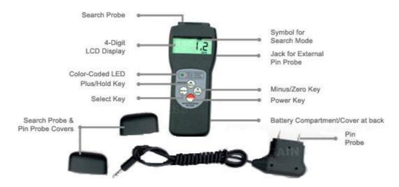
A fronte di un sospetto circa la presenza di acqua dovuta ad uno spandimento piuttosto che a fenomeni di muffa o di umidità di risalita capillare, si utilizza un igrometro di contatto, specifico per le rilevazioni in edilizia del grado di umidità degli elementi analizzati
